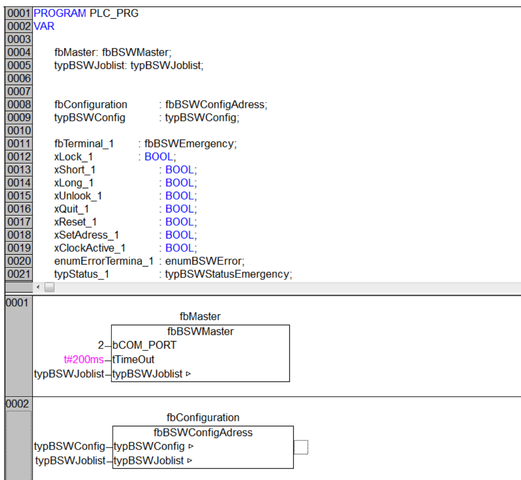
Abb. 3: PLC PRG – BSW Masterbaustein – BSW Konfigurationsbaustein
